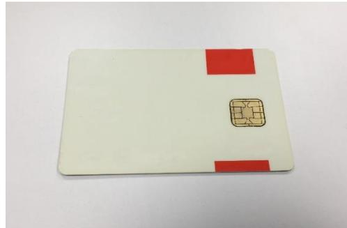
Abbildung 5: Chip-Karte mit nicht sichtbarem RFID Transponder
