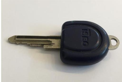
Abbildung 1: Schlüssel einer mechatronischen Schließanlage (Hybrider Schlüssel)
