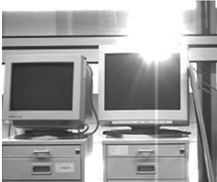
Abbildung 6: Smear-Effekt auf einem Bildschirm - Quelle: wikipedia
